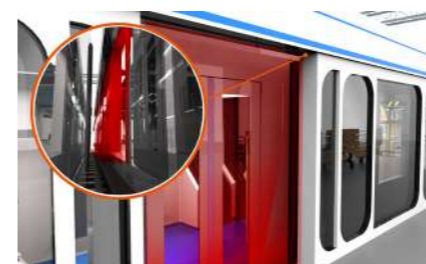
乗客有無を検知しスクリーンドアを開閉 ※KRS韓国鉄道標準規格獲得
